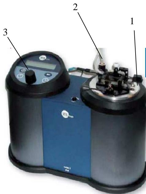
Rysunek 11. Aparat Setaflash do oznaczania temperatury zapłonu w tyglu zamkniętym: 1 – mosiężny tygiel umieszczony w stalowym naczyniu, 2-termometr, 3-mieszadełko.
