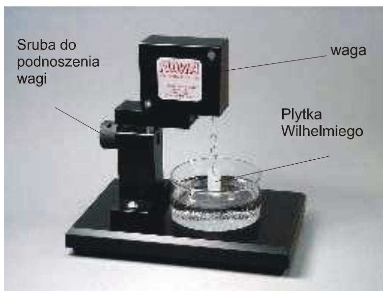
Rys. 3. Tensjometr NIMA ST 9000
